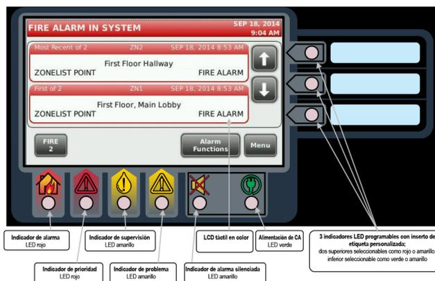
Figura 2: Pantalla táctil con indicadores LED de estado
