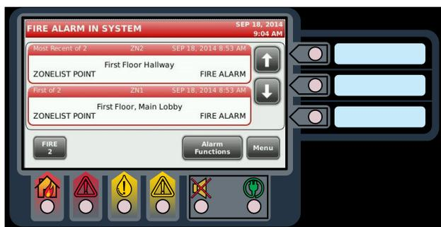
Figure 2: Pantalla táctil con indicadores LED de estado
